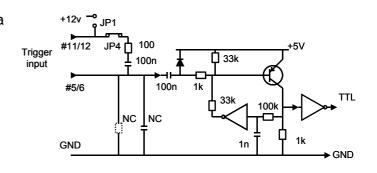
Fig. 5. Trigger input.
