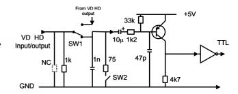
Fig. 6. HD and VD input.
