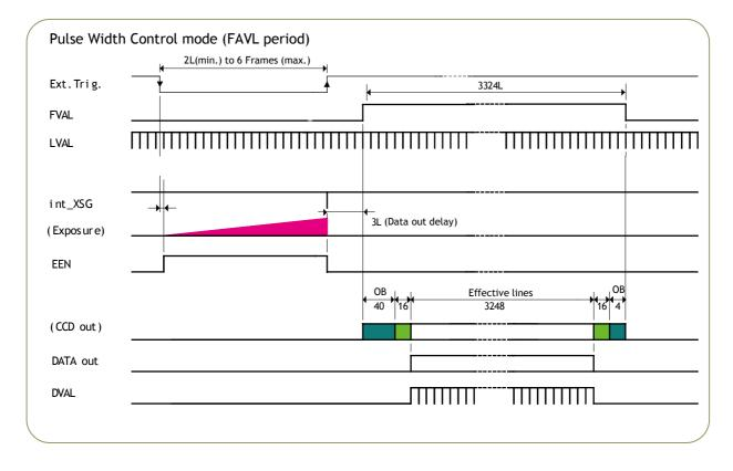
Fig. 20. Pulse width trigger mode
