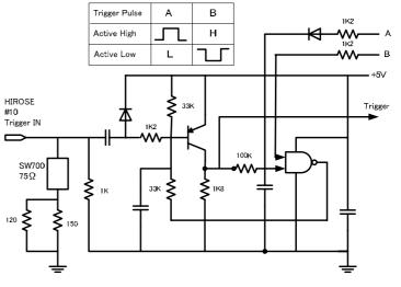
Fig.4. Trigger input
