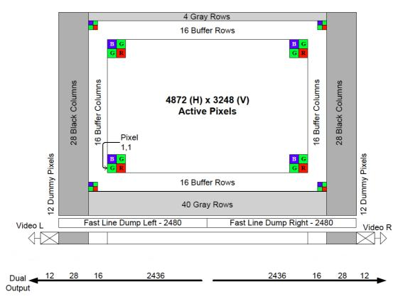
Fig. 12. CCD sensor layout
