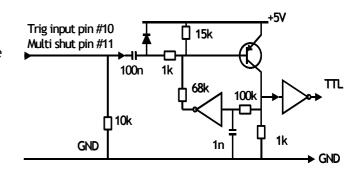
Fig. 6. Trigger input.
