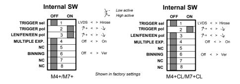
Fig. 26. Internal Switch
