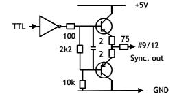
Fig. 7. Composite Sync. output
